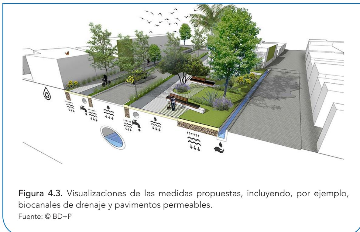
**Figura 4.3.** Visualizaciones de las medidas propuestas, incluyendo, por ejemplo, biocanales de drenaje y pavimentos permeables.
