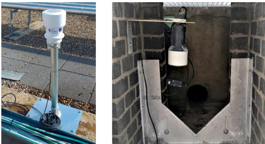
FIGURA 6: PLUVIÓMETRO Y MEDIDORES DE NIVEL.
