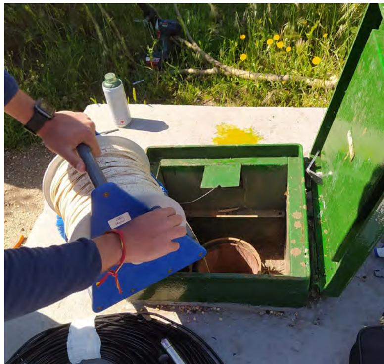
Medición manual del nivel piezométrico
