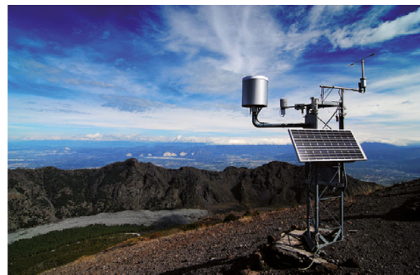
Una estación meteorológica es una instalación destinada a medir y registrar regularmente diversas variables meteorológicas como, por ejemplo, la temperatura, la radiación solar, la pluviometría, la humedad relativa, etc.
