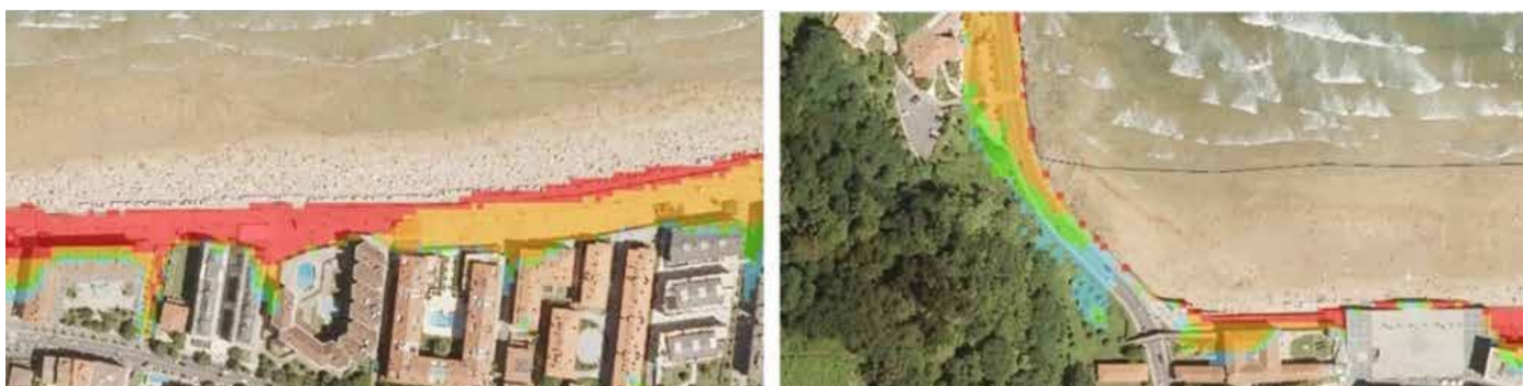
Figura 14. Detalle de la zona con riesgo de inundación por oleaje extremo con Tr=50 años en Zarautz, bajo condiciones del NMM proyectado para el año 2100 con RCP4.5 . Los colores indican los rangos de altura de la lámina de agua (en metros) en dichas zonas inundables. A la izquierda se muestra una zona situada en el centro-oeste del paseo marítimo y a la derecha la zona oeste que comprende el puerto, la Munoa, el palacio de Narros, el puerto y la carretera Zarautz-Getaria.
