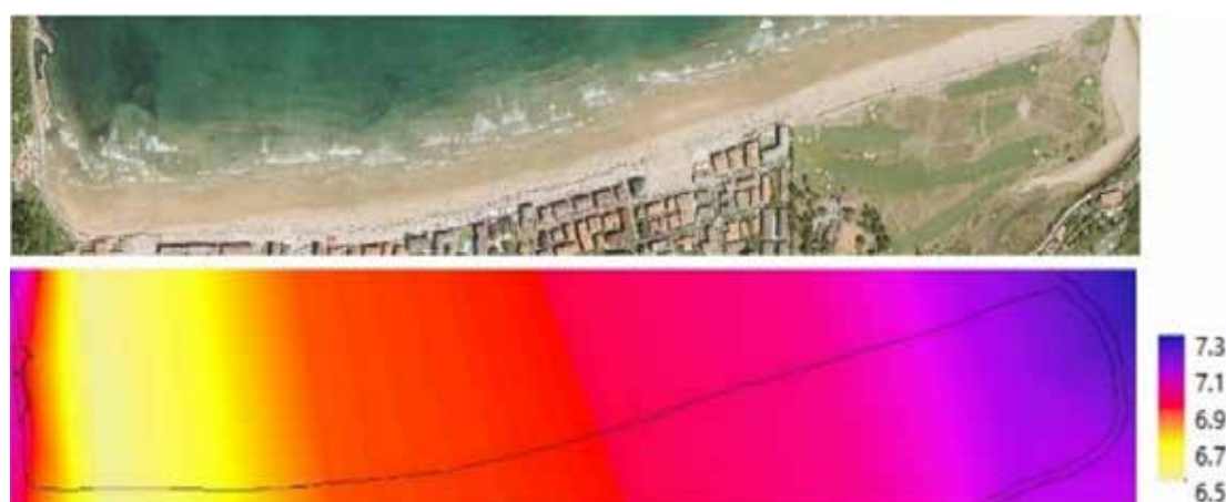
Figura 11. (Arriba) Ortofoto de la playa de Zarautz. (Abajo) Distribución de la CI (m) sobre el NMM IGN-2008 por oleaje extremo ( T_r = 50 años), a lo largo de la franja litoral de Zarautz. La línea negra delimita la línea de costa.
