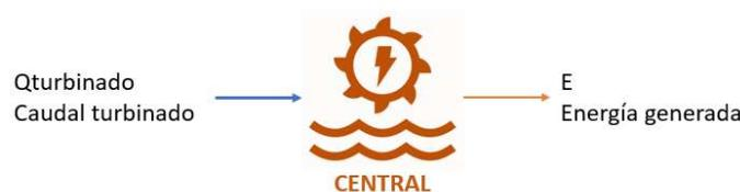
**En centrales que turbinan agua procedente de un embalse,** la energía generada se obtiene multiplicando el caudal de entrada (caudal turbinado) por el coeficiente energético de la central ( $\text{kWh/m}^3$ ). Este se determina, para cada paso de tiempo, a partir de las curvas cota-eficiencia-volumen como función del volumen útil embalsado.
