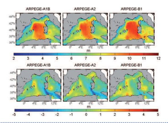
Figura 3.7.24: Arriba: niveles de retorno de Hs (en m) para 50 años calculados para el periodo 2060-2099 a partir del modelo WAM forzado con downscalings dinámicos de ARPEGE bajo distintos escenario de emisiones. Abajo: diferencias entre éstos y los calculados para los respectivos periodos de control 1958-1999.
