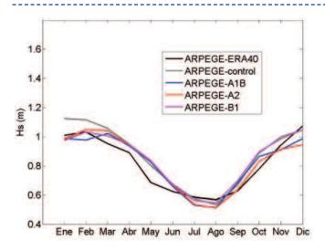
Figura 3.7.16: Comparación de ciclos estacionales de oleaje promediados sobre el dominio del Mediterráneo occidental: modelo WAM forzado con downscaling dinámicos del modelo ARPEGE bajo distintos escenario de emisiones (líneas continuas) y los respectivos periodos de control 1958-1999 (líneas discontinuas). Se incluye también el ciclo estacional obtenido con el downscaling de ERA-40
