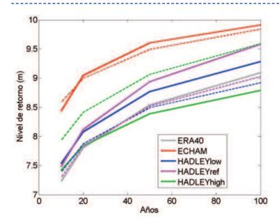
Figura 3.7.27: Niveles de retorno promedio en el dominio Atlántico calculados para el periodo 2060-2099 a partir de las simulaciones forzadas con los downscalings dinámicos de distintos modelos atmosféricos, todos bajo el escenario de emisiones A1B (líneas continuas) y para las correspondientes simulaciones de control (período 1958-1999, líneas discontinuas).
