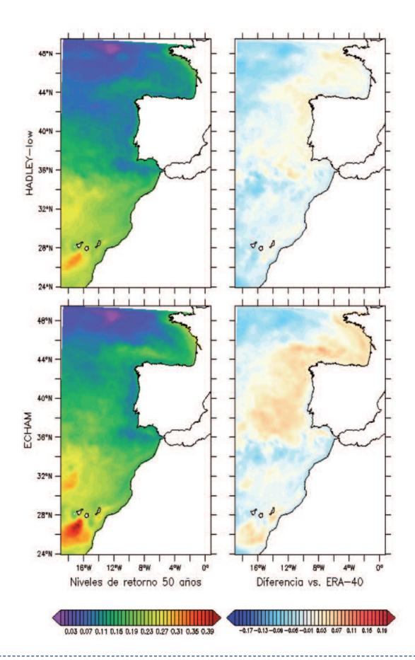
Figura 3.8.12: Izquierda: Niveles de retorno a 50 años de la componente baroclina de nivel del mar (en m) obtenida de los controles forzados con HADLEY-low y ECHAM (1961-2000). Derecha: diferencias (en m) respecto a los niveles de retorno del hindcast forzado con ERA-40.
