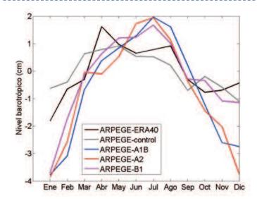
Figura 3.9.10: Ciclo estacional promedio de la componente atmosférica de nivel del mar (cm) calculado para el periodo 2060-2099 a partir de los resultados del modelo HAMSOM forzado con downscalings dinámicos de ARPEGE obtenidos bajo distintos escenarios de cambio climático.
