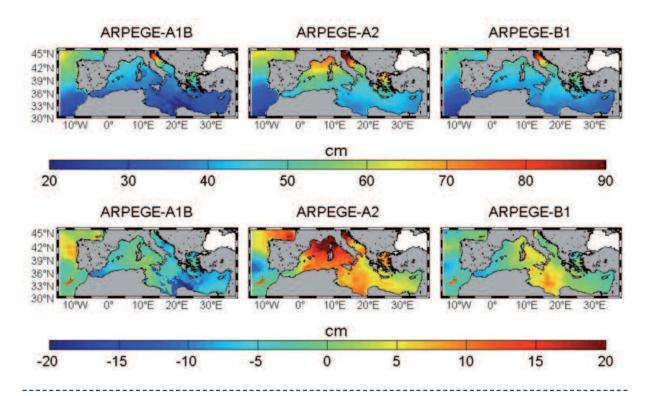
Figura 3.9.13: Arriba: niveles de retorno de la componente atmosférica de nivel del mar para 50 años (en cm) correspondientes al periodo 2060-2100 (modelo HAMSOM forzado con ARPEGE bajo distintos escenarios de emisiones). Abajo: diferencias entre éstos y los niveles de retorno calculados para el periodo de control 1958-1999.
