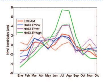
Figura 3.9.8: Ciclo estacional promedio de la componente atmosférica de nivel del mar (cm) calculado para el periodo 2060-2099 (modelo HAMSOM forzado con downscalings dinámicos de distintos modelos atmosféricos, todos bajo el escenario de emisiones A1B; líneas continuas) y para los correspondientes periodos de control 1958-1999 (líneas discontinuas).
