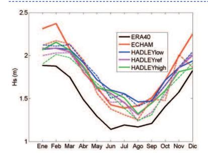
Figura 3.7.19: Comparación entre ciclos estacionales de oleaje promediados sobre el dominio del Mediterráneo occidental: modelo WAM forzado con downscaling dinámicos de distintos modelos atmosféricos, todos bajo el escenario de emisiones A1B (líneas continuas) y los respectivos periodos de control 1958-1999 (líneas discontinuas). Se incluye también el ciclo estacional obtenido con el downscaling de ERA-40.
