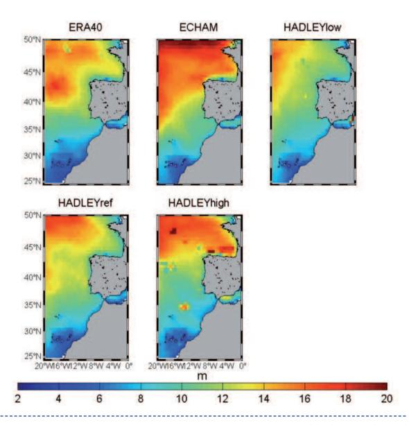
Figura 3.7.11: Niveles de retorno de Hs (en m) para 50 años, calculados para el hindcast forzado con el downscaling de ERA-40 con RCA3.5 y para los controles de ECHAM, HADLEY-low, HADLEY-ref y HADLEYhigh. Todo ello para el periodo común 1958-1999.
