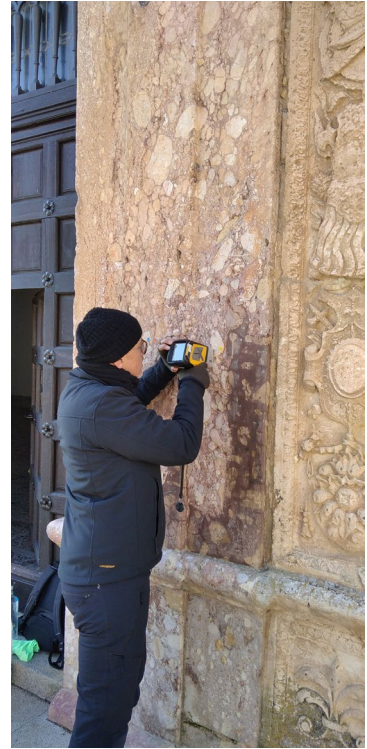
Caracterización in situ mediante un equipo portátil de fluorescencia de rayos X de los sillares de conglomerado de Espejón (Soria), empleado en la portada renacentista del palacio de los Condes de Miranda (Peñaranda de Duero, Burgos). / VIRGINIA GARCÍA-ENTERO
