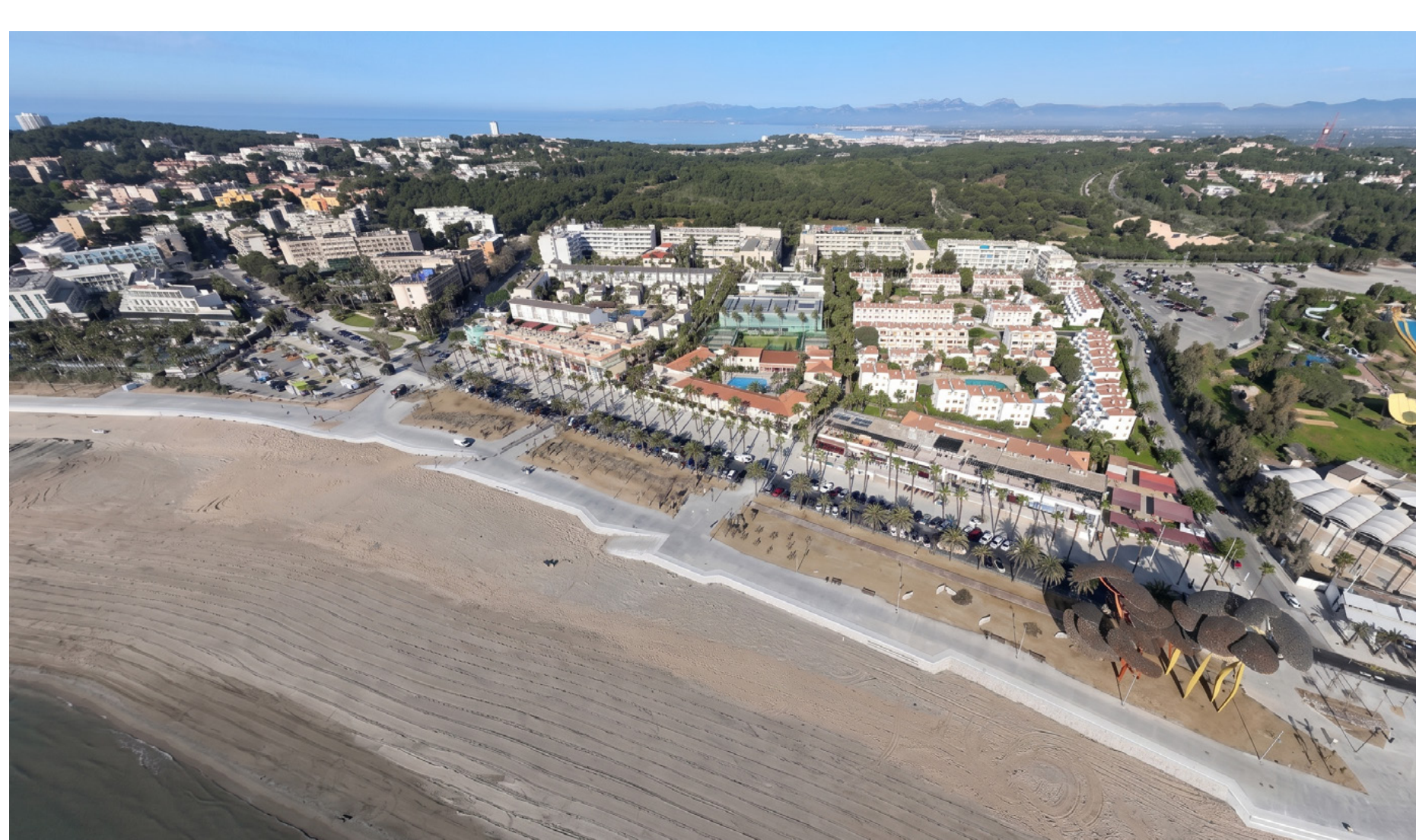
El paseo de la Pineda después del retranqueo, sin carretera y con el sistema de contención en grada.
